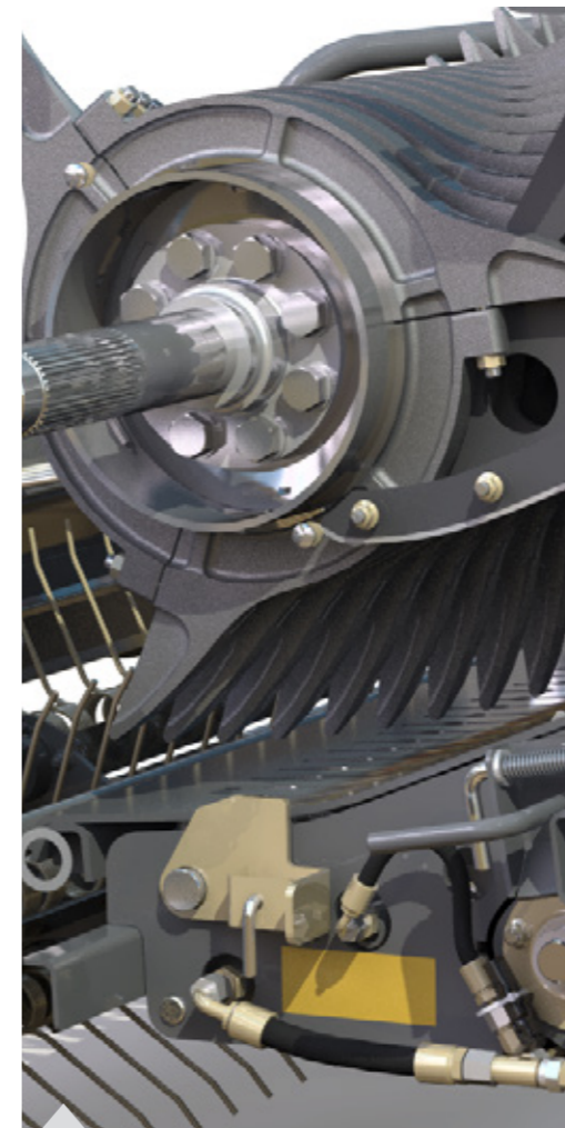
Strona 24 Opcje cięcia — przedstawiamy rotor z nożami ProCut
