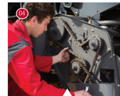
04 Sprawdzenie naprężenia łańcucha podbieracza.
