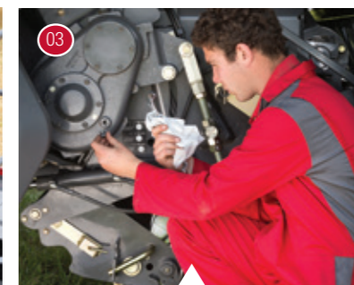
03 Sprawdzenie poziomu oleju w przekładni rotora.
