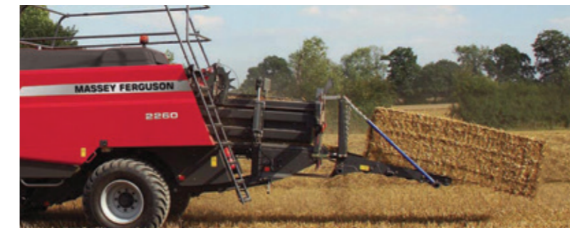
Zintegrowany system waży bele wychodzące z komory na rampę.
