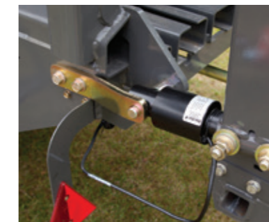
Bardzo dokładne czujniki w zintegrowanym systemie ważenia bel.
