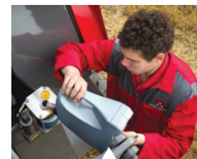
Uzupełnianie oleju automatycznej olejarki do łańcuchów.
