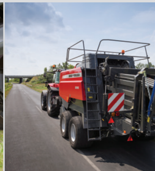
Oś tandemowa zapewnia dużą prędkość jazdy po drogach i doskonały komfort jazdy między polami.
