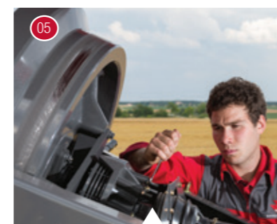
05 Regulacja sprzęgła poślizgowego koła zamachowego.
