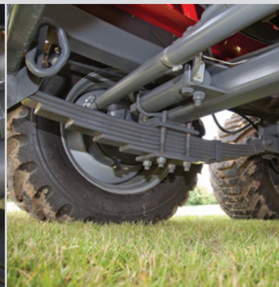
Niezależne resory piórowe każdego koła.
