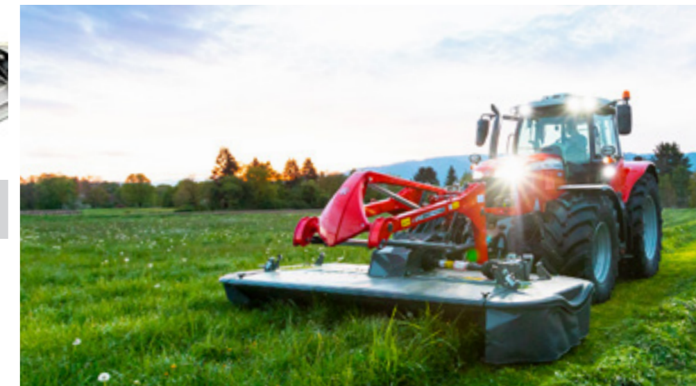
Niskoprofilowa listwa tnąca z przekładnią zębatą czołową
