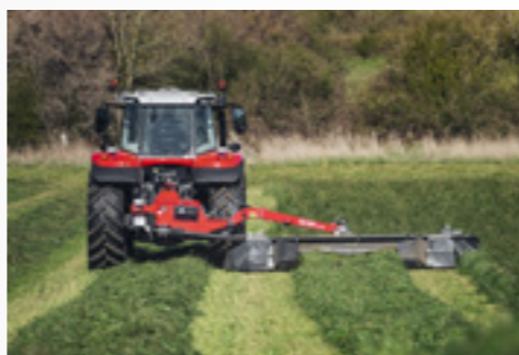
Niskoprofilowa listwa tnąca z przekładnią zębatą czołową
