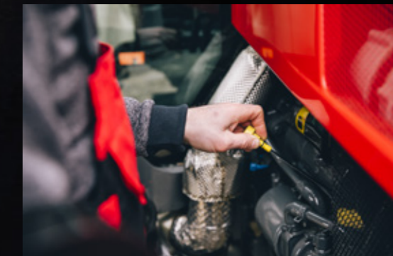
Konstrukcja przedniej osi oraz smukła i wąska maska ułatwiają dostęp do bagnetu poziomu oleju i filtra.
