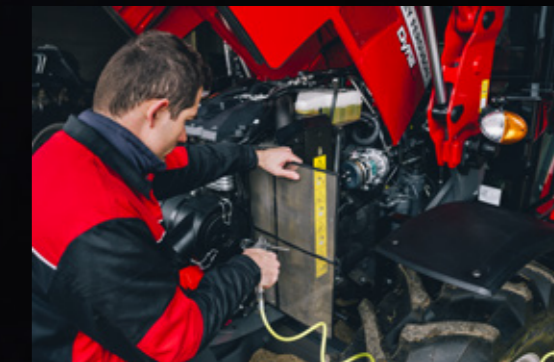
Zespół chłodzenia silnika jest łatwo dostępny, dzięki czemu jego czyszczenie przebiega szybciej i łatwiej.
