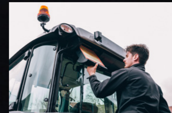
Łatwy dostęp na wypadek demontażu filtra powietrza kabiny w celu jego oczyszczenia.
